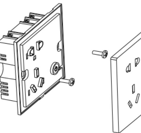
1. 用十字螺丝刀将面框拆下；
